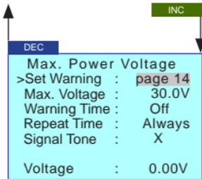
überwacht den Akku an Anschluss 1. Die Warnschwelle ist einstellbar von bis in 0.1 V Schritten.
