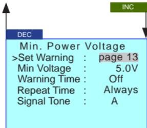
überwacht den Akku an Anschluss 1. Die Warnschwelle ist einstellbar von bis in 0.1 V Schritten.
