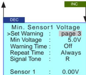
überwacht den an Buchse 5 über Sensor 1 angeschlossenen Akku. Die Warnschwelle ist einstellbar zwischen 0 und 80.0 V in 0,1 V Schritten.
