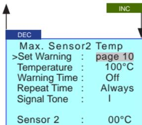
überwacht den an Buchse 7 über Sensor 2 angeschlossenen Temperatursensor. Die Warnschwelle ist einstellbar zwischen -20 und 200° C in 1° C Schritten.
