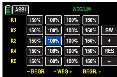
Entsprechend häufiges Antippen der **+**-Taste am rechten Displayrand erhöht den Wert des aktiven Optionsfeldes. Antippen der **-**-Taste darunter reduziert den aktuellen Wert des aktiven Feldes und Antippen der **RES**-Taste setzt einen veränderten Wert wieder auf den Standardwert zurück.
