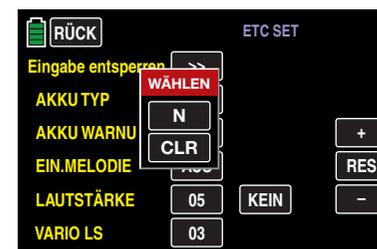
Antippen von **N** bricht den Vorgang ab. Antippen von **CLR** löscht ggf. einen bereits zugewiesenen Geber. Bewegen Sie dagegen einen der Geber DV1 oder DV2, SL1 oder SL2, wird dieser als Lautstärkensteller zugewiesen, beispielsweise:
