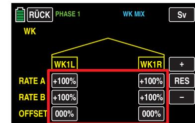
... auf die standardmäßigen Wölbklappenservos 6 und 7, oder bei einem Modell mit nur einem Wölbklappenservo nur auf Servo 6.
