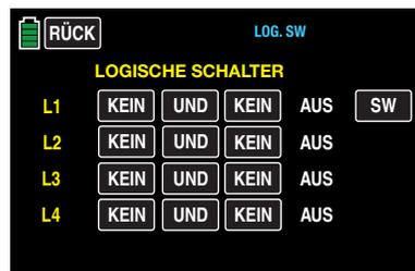
Das Ergebnis einer solchen logischen Schaltfunktion – im Display rechts ausgewiesen – kann als weitere Schaltfunktion verwendet werden.
