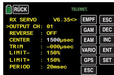
Den ausgewählten Wert verändern Sie innerhalb des möglichen Einstellbereiches mit der **INC** oder **DEC**-Taste und in den Speicher des Empfängers übernommen wird ein geänderter Wert durch nochmaliges Antippen der **SET**-Taste. Durch Antippen der Taste **ESC** rechts oben im Display kehren Sie zur vorherigen Seite und durch Antippen der Taste **RÜCK** links oben im Display zur Ausgangsposition zurück:
