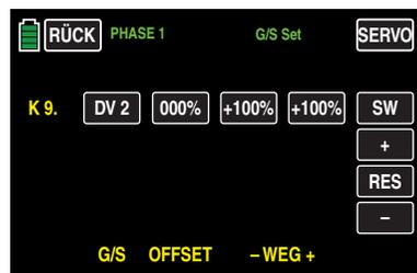
Ist dem Eingang „9“ ein Geber zugewiesen, erübrigt sich die eventuell von anderen Fernsteuersystemen zu diesem Zweck gewohnte Programmierung von zwei Phasen – „mit Gasvorwahl“ und „ohne Gasvorwahl“ –, da sich die Erhöhung der Systemdrehzahl unterhalb des Schwebeflughpunktes mit den entsprechenden Optionen des Senders **mz-18**
