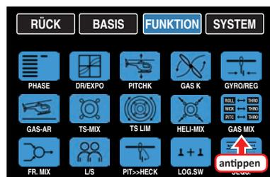
Nicht nur eine Pitchvergrößerung erfordert eine entsprechende Gasmitnahme, sondern auch große zyklische Steuerbewegungen, d. h. das Kippen der Taumelscheibe in eine beliebige Richtung. Aber auch eine Erhöhung des Heckrotorschubes erfordert eine entsprechende Anpassung der Motorleistung, um die Systemdrehzahl konstant zu halten. In den Programmen des Senders **mz-18** HoTT Pro kann die Gasmitnahme getrennt für die Roll-, Nick- und Heck-Steuerung angepasst werden.
