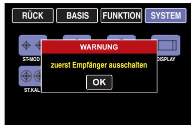
... eingeblendet, besteht noch eine Verbindung zu einem betriebsbereiten Empfänger. Schalten Sie diesen ab und wiederholen Sie den Vorgang.
