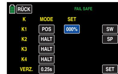
Bringen Sie nun das Bedienelement dieses Steuerkanals in die gewünschte Position und tippen Sie dann zu deren Übernahme in das Wertefeld auf die Taste **SET** rechts unten im Display, beispielsweise:
