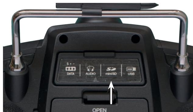
Neben der mit dem Sender **mz-18** HoTT Pro standardmäßig mitgelieferten können alle handelsüblichen micro-SD-Speicherkarten mit bis zu 2 GB und micro-SDHC-Karten mit bis zu 32 GB Speicherplatz im Sender benutzt werden. Herstellerseitig empfohlen wird jedoch die Verwendung von Speicherkarten mit maximal 4 GB, da deren Kapazität im Normalfall völlig ausreicht.
