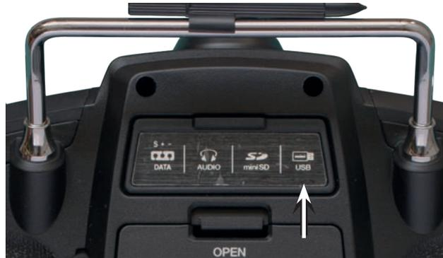
An diese Buchse wird das dem Set beiliegende USB-Kabel angeschlossen. Die Vorgehensweise bei Software-Updates über den PC wird in der dem Softwarepaket beigefügten Anleitung beschrieben.
