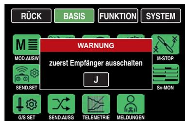
..., dann besteht noch eine Verbindung zwischen Empfänger und Sender. Schalten Sie also Ihren Empfänger aus und probieren Sie es noch einmal. Im Lieferzustand des Senders sieht dann beispielsweise das Modelltyp-Display eines beliebigen Modellspeichers so aus:
