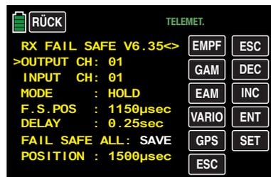
Nach erneutem Antippen der **SET**-Taste rechts unten im Display wechselt die Anzeige wieder von „SAVE“ nach „NO“. Die Positionen aller von dieser Maßnahme betroffenen Servos wurden damit abgespeichert und parallel dazu in die Zeile „F.S.Pos.“ übernommen, sodass der Empfänger im Störfall darauf zurückgreifen kann. Die Bedienelemente des Senders können Sie nun wieder loslassen.
