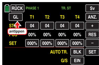
... stellt die Trimmung der Steuerfunktionen 2 ... 4 von phasenübergreifend („**GL**(obal)“) auf „phasenspezifisch („**PH**(ase)“), und umgekehrt, um.
