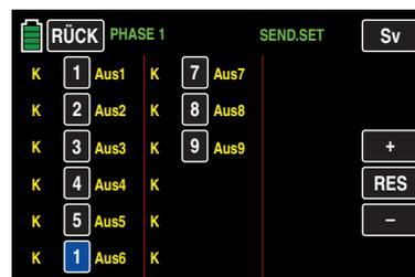
Antippen der Taste **RES** setzt einen geänderten Ausgang auf die Standardzuordnung zurück.
