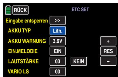
Durch Antippen der Tasten **+** oder **-** am rechten Displayrand wählen Sie nun den passenden Akkutyp aus, z. B.:
