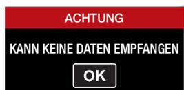
... ist zwar Ihr HF-Modul eingeschaltet, es besteht jedoch keine Verbindung zu einem Empfänger. Schalten Sie also Ihre Empfangsanlage ein und/oder binden Sie diese korrekt und wiederholen Sie den Vorgang.
