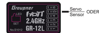
... alternativ nicht nur das Adapterkabel mit der Best.-Nr. **7168.6S** zum Updaten des Empfängers sondern auch ein Telemetrie-Sensor angeschlossen werden.
