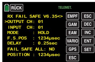
Schalten Sie den Sender aus und überprüfen Sie die Fail-Safe-Positionen anhand der Servoausschläge.
