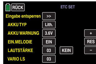
Zum Setzen einer individuellen PIN die Taste **>>** in der Zeile „Eingabe entsperren“ antippen:
