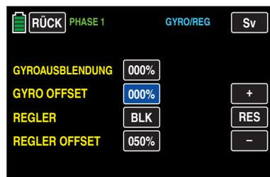
Basierend auf diesen phasenspezifisch festgelegten (Offset-) Einstellungen kann die Gyrowirkung mit einem in der Zeile „Gyro“ im Untermenü »G/S SET« zugewiesenen Geber zusätzlich stufenlos variiert werden.
