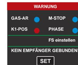
... ist der aktuell aktive Modellspeicher derzeit an keinen Empfänger „gebunden“. Durch Antippen der Taste **SET** gelangen Sie unmittelbar in das Untermenü »**Sendereinstellung**«, ...
