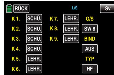
Da zu diesem frühen Zeitpunkt der Programmierung eines LS-Systems kaum ein betriebsbereiter Schüler-Sender am Lehrer-Sender angeschlossen sein wird, reagiert der Sender sofort auf den im Zuge der Schalterzuordnung geschlossenen Schalter mit akustischen Warnhinweisen. Parallel dazu würde in der Grundanzeige des Senders im Sekundentakt links oben eine Warnmeldung erscheinen, siehe Abbildung am Ende dieses Abschnittes. Öffnen Sie also wieder den eben zugewiesenen Schalter.
