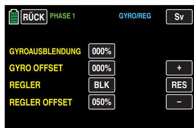
Wie in obiger Abbildung dargestellt, ist diese Option standardmäßig **BLK**, d. h. ausgeschaltet, sodass der Steuerkanal 8 uneingeschränkt „normal“ nutzbar ist.
