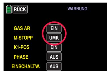
Während mit **EIN** die Einschaltwarnung bei eingeschaltetem GAS AR und/oder Motorstopp aktiviert wird, akti-
