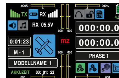
Bei Unterschreiten einer im Display „**RX SERVO TEST**“ des Untermenüs „EINSTELLEN, ANZEIGEN“ des »**Telemetrie**«-Menüs einstellbaren Warnschwelle – standardmäßig 3,8 V – erfolgt eine optische und akustische Unterspannungswarnung.
