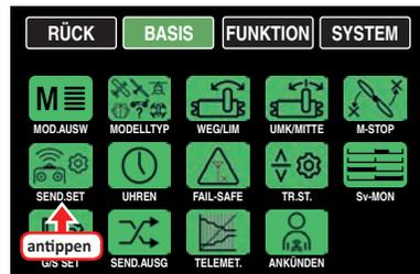
In diesem Untermenü werden senderspezifische Funktionen wie z. B. „Binden“, „Senderausgänge“, „HF AN/AUS“, „HF-Typ“, „Reichweitentest“ und „DSC-Ausgang“ konfiguriert:
