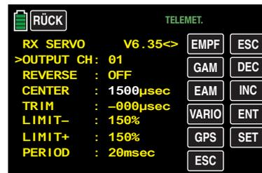
Nun bewegen Sie den entsprechenden Geber, Steuerknüppel und/oder Trimmgeber in die gewünschte Position und speichern die aktuelle Geberposition durch erneutes Antippen der Taste **SET**. Diese Position wird als neue Neutralposition abgespeichert.
