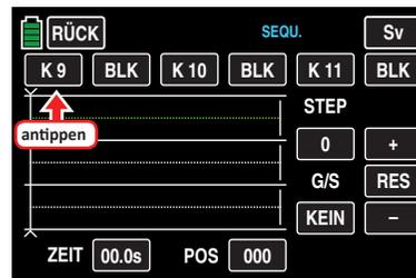
... in dem nun blauen, und somit aktiven, Wertefeld die aktuelle Einstellung durch Antippen der + -Taste oder -Taste am rechten Displayrand. Zur Auswahl stehen die Kanäle 5 ... 9, z. B.:
