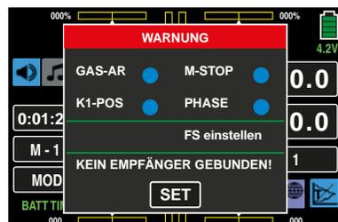
Im Prinzip gleiches gilt für die Warnoption „M-STOP“, jedoch mit dem Unterschied, dass im Untermenü »**Warnung**« des Systemmenüs modellspezifisch gewählt werden kann, ob vor ein- oder ausgeschalteter Motor-Stopp-Funktion gewarnt wird:
