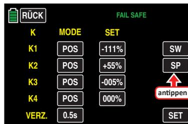
Die erfolgte Abspeicherung wird im Display kurzzeitig bestätigt und parallel dazu werden die **POS**-Wertefelder wieder ausgeblendet:
