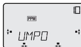
Mit dieser Funktion lässt sich die Servo-Drehrichtungen aller acht Servos elektronisch umpolen. Dadurch muss bei der Montage der Servos im Modell keine Rücksicht auf die Drehrichtung genommen werden.
