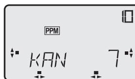
Bei Auswahl des 2. Querruderausgangs auf Kanal 7 wird automatisch die Zumischung der Klappenfunktion abgeschaltet.
