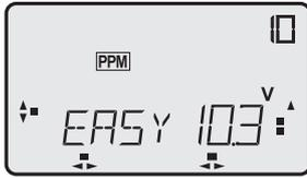
Nach dem 6. Trimmschritt ist der oberste Anzeigepunkt erreicht. Die Anzeige wechselt, es wird nur noch ein Pfeil angezeigt, der in die Richtung zeigt, in welche die Trimmung verändert wurde.
