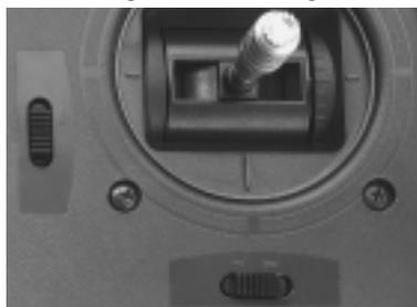
Eine Steuerknüppeltrimmung wird benötigt, um in Neutralstellung der Steuerknüppel auch ein geradeaus fahrendes oder fliegendes Modell zu erhalten. Kleine Korrekturen der Mittelstellung werden mit der Trimmung durchgeführt.
