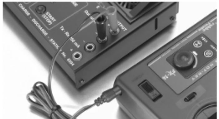
Der Senderakku kann geladen und entladen werden ohne ihn auszubauen. Die Ladebuchse befindet sich im rechten Seitenteil neben dem Ein/Aus -Schalter.
