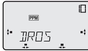
Mit dieser Funktion kann der Motor abgeschaltet werden, ohne die Leerlauftrimmung zu verändern. Dazu wird ein externer Mischerschalter benötigt, welcher auf Steckplatz 5 eingesteckt wird (siehe Kapitel 4.7).
