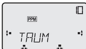
Mit diesem Menü wird das Mischprogramm HELI auf den im Hubschrauber verwendeten Taumelscheibentyp abgeglichen.
