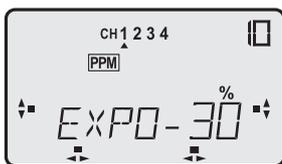
Mit einer Drehung am 3-D-Hotkey stellt man den gewünschten %-Wert für die Exponential-Funktion ein. Durch Drücken des 3-D-Hotkeys für 1 Sekunde wird wieder der Ausgangswert (0%) eingestellt.
