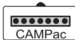
Sender ausschalten, Modul vorsichtig so einsetzen, dass Beschriftung und Nase des Moduls mit der auf der Platine aufgedruckten Zeichnung übereinstimmen.
